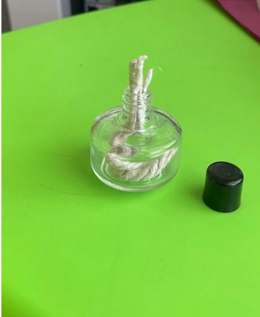
*Ilustración 2 Frasco de una muestra de perfume utilizado como lámpara de alcohol.*
