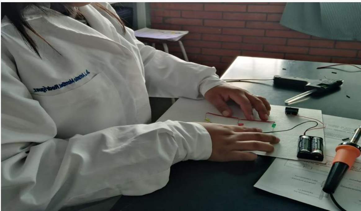
Fotografía 2. Se soldán las terminales positivas con (+) y negativas con (-).
