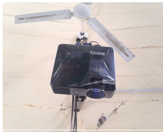
14. Proyector con capacidad de conexión inalámbrica mediante un dongle que se le conecta vía USB al proyector
